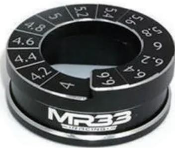
MR33は、1/10スケールのオンロード車のサスペンショントラベルを設定するための全く新しいゲージを提案します。新しい「サークルドループゲージ」の測定範囲は4.0～6.6mmで、1/10スケールで必要とされる範囲を完全にカバーします。新しい円形デザイン（直径40mm）により、通常のストレートバージョンよりも車両の下に配置しやすくなっています。シャシーやバンパー、スイングアームにぶつかることもなく、重要なポイントであるドループの正確な調整がより簡単になりました。すべての標準10mmドループブロックは、新しい「MR33サークルドループゲージ」と一緒に使用する必要があります。
