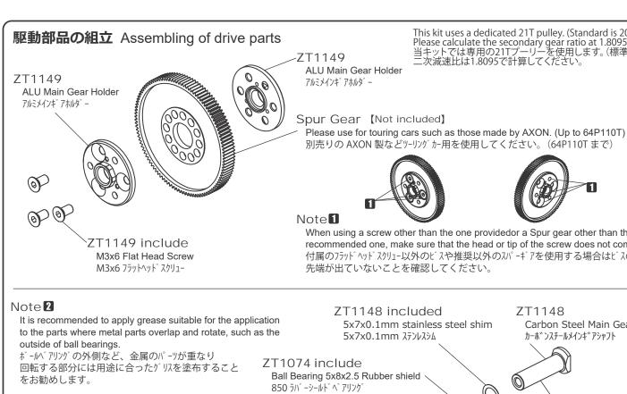
This kit uses a dedicated 21T pulley. (Standard is 20T) Please calculate the secondary gear ratio at 1.8095. 当キットでは専用の21Tプーリーを使用します。(標準は20T) 二次減速比は1.8095で計算してください。
