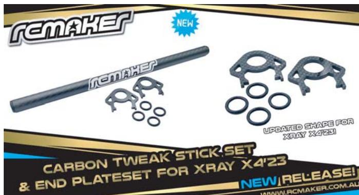
XRAY X4'23 用のカーボンファイバーツィークスティックをご紹介します。フルカーボンファイバー製で軽量、分解して簡単に持ち運ぶことができます。ツィークスティックは、片手で平らな面に車を固定し、もう片方の手でトップデッキのネジを締め付けることができます。X4 の全く新しいデザインは従来のショックタワーを持たないため、ツィークスティックは前後・左右のバルクヘッドに均等に圧力をかけるエクステンションプレートを利用しています。この設計では、位置決め突起でアッパーバルクヘッドにエクステンションを配置するため、迅速、簡単、正確に使用することができます。厚みのある O リングはエクステンションを所定の位置に固定するだけで、お好みの距離に調整することができます。ツィークスティックの使用は、車のすべての部分とすべてのサイズのスパーギアをクリアするため、何かを取り外す必要はありません。絶対に必要なアイテムです。
