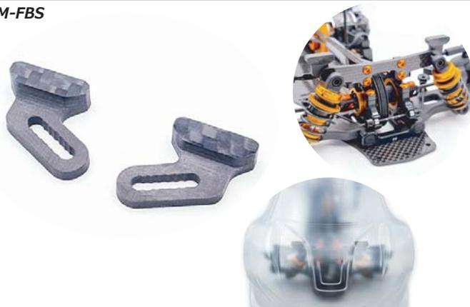
フロントボディスタビライザーはダウンフォースをフロントショックの上部に直接伝え、コーナーでのステアリングとストレートでの安定性を高めます。また、コーナリング時にボディがタイヤに干渉するのを防ぎます。ホイールアーチの摩擦は、コーナースピードに影響があります。ホイールアーチ上でボディシェルを幅広くサポートすることにより、コーナリング中のボディシェルのローリングを防ぎます。高さ調節が可能です。
