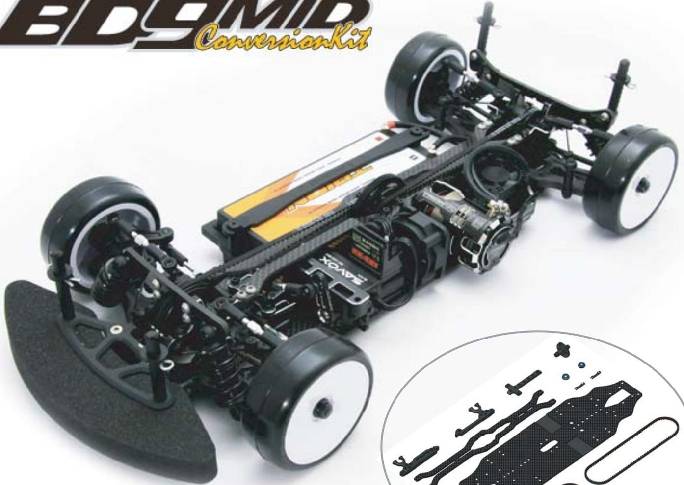
この製品はYOKOMO BD9をベース車としたコンバージョンキットです。ベルト長の前後差をなくすことでスロットル操作時のタイムラグを極力減らし、運転しやすくすることが開発の目的です。結果的にモーターが中央側にレイアウトされ、バランスの良いミッドシップレイアウトの実現が可能になりました。また昨今のバッテリーの進化によりショートリポバッテリーを使用してのシャーシバランス優先のレイアウトも可能にいたしました。(ショートリポバッテリー搭載のためにはオプションパーツが必要です。)
