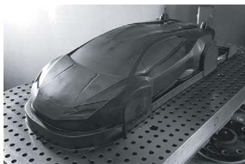
AGATA GT12 のデザインは GT12 クラスに最適な走行性能を満たすために調整されています。ワイドキャブと自然なサイドラインからリアウィングに安定した空気の流れを生みます。それはとても安定したドライビングフィールにつながります。ボディは 3D CAD でデザインされ 5 軸の CNC によって精度を第一に製作されています。
