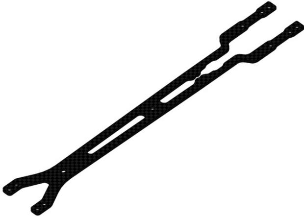
XRAY T4 '17用の国産カーボン製アッパーデッキです。ハイグリップ路面で使用するによりシャーシロールが増え操作がマイルドになります。外形は純正と同形状。厚さは1.65mmとなります。強度を優先するためLAYSHAFT 前側固定ビス取付穴を無くしました。
