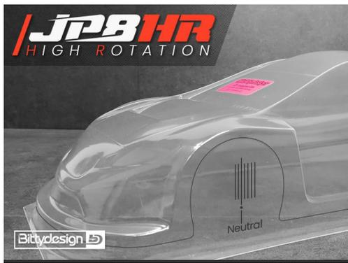
ボディには搭載位置を前後に調整するためのラインが施してあります。懸命なテストの結果 ETS や CRC のようなハイグリップカーペットではニュートラルな位置に JP8HR を搭載することをお勧めします。アウトドアでは 4~6mm 前方に搭載することでより旋回量が増します。
