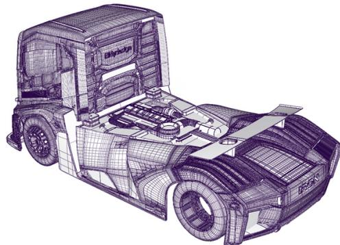
IRON プロジェクトを実現するために最先端のグラフィック技術と 3DCAD を駆使してボディの設計の設計を行いました。それは品質を重要視するために妥協することなく行われました。型の製造は 5 軸 CNC で行われ細部も完璧に製造されたものを使用しています。
